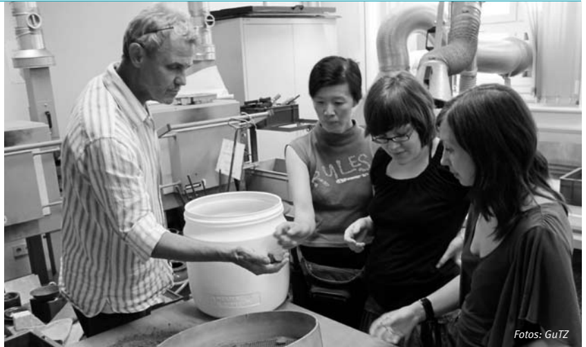
Viele Modelle aus dem Rapid-Prototyping-Prozess finden in der Gießerei Verwendung. Hier im Labor für Gießereitechnik am Fachbereich VIII, demonstriert Laborleiter Prof. Dr. Paasch den Teilnehmerinnen die hohe Abformgenauigkeit des verwendeten Formsandes.
